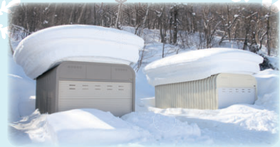
※当社札幌工場敷地内での耐雪試験の状況です。危険ですので絶対に真似をしないで下さい。
